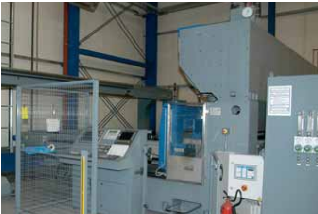
Schnittstelle: An der Bedienerstation muss der Mitarbeiter nur das jeweilige Programm für den Auftrag vom zentralen Server abrufen
