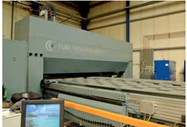
Prozesssicher: Die automatische Laserschweißanlage TS 4.20 arbeitet mit hundertprozentiger Schweißparameterkontrolle. Ihr Positioniertisch nimmt Blechtafeln bis 4100 mm x 2050 mm auf
