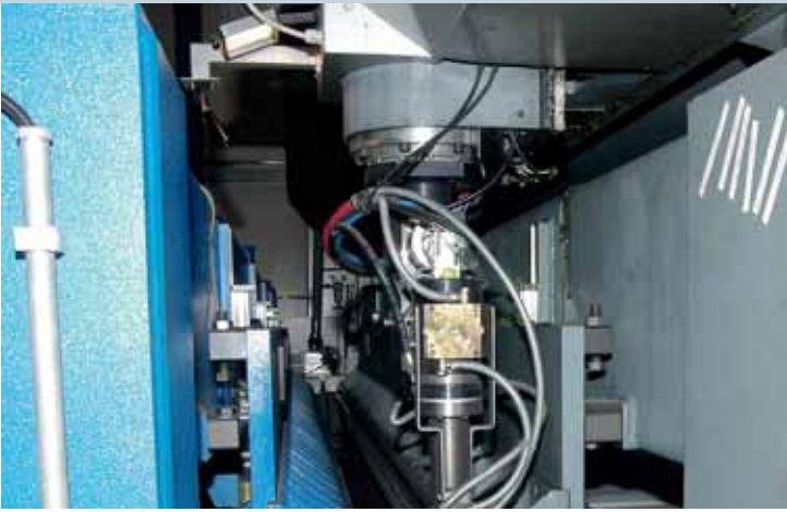
Herzstück: Der Laserschweißkopf mit einer Leistung von 5 kW
